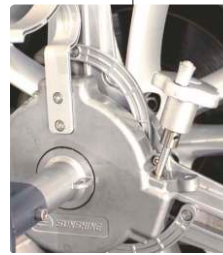
Drehmoment-Rad zum Schutz der Felge
