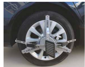
Hohe Präzision durch Dreipunktklemme
