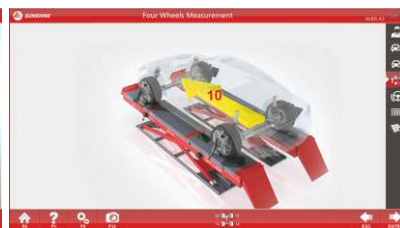
Schnelle Felgenschlagkompensation durch Vor- und Zurückschieben
