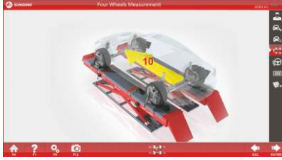
Schnelle Felgenschlagkompensation durch Vor- und Zurückschieben
