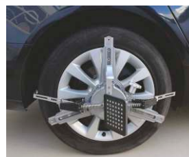
Hohe Präzision durch Dreipunktklemme
